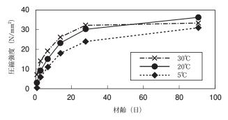
図 2. コンクリートの材齢と圧縮強度 (W/C=55%)
