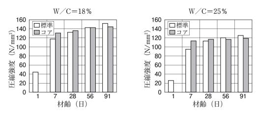
図1. 圧縮強度試験結果の一例
