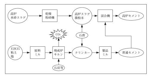
図 1. 高炉セメントの製造方法
