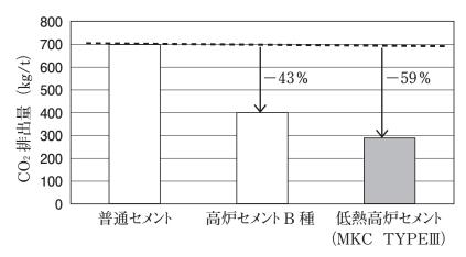
図3. 普通セメントと高炉セメントの CO<sub>2</sub> 排出量比較
