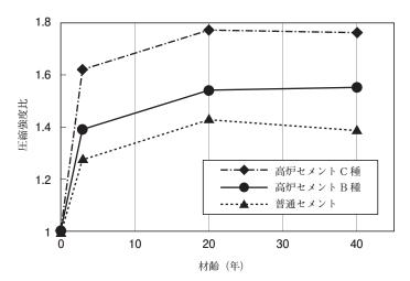
図3. 28日強度を1とした時の圧縮強度比
