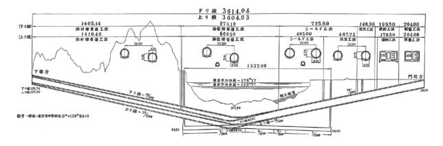
図1. 関門トンネル縦断面図1)
