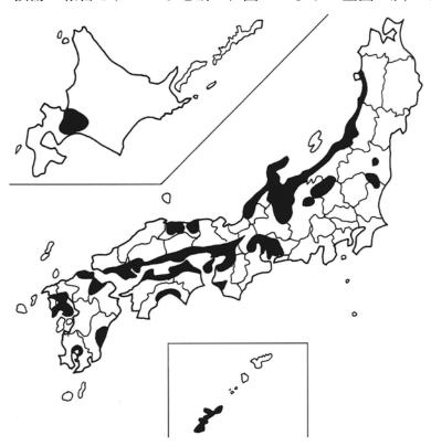
図1. アルカリ骨材反応による構造物の損傷が報告されている地域
