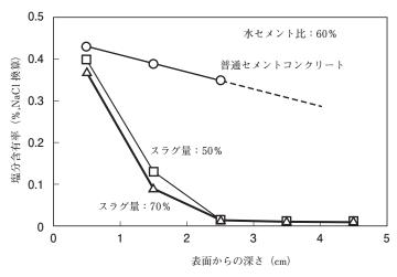
図 1. 高炉スラグコンクリートの塩化物の浸透
