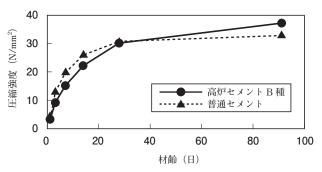
図1. コンクリートの材齢と圧縮強度(W/C=55%)
